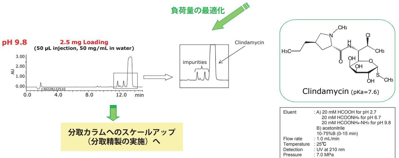
塩基性医薬品成分であるクリンダマイシンの分取精製条件の検討例を示しています。イオン性化合物は、非イオン化状態で保持が大きくなるとともに、負荷量が向上する傾向があります。移動相pHを変えてクリンダマイシンの分離を比較すると、移動相pHが高いほど保持が大きく分離能に優れ、負荷量によるピーク形状の変化は小さくなっています。YMC-Triart C18は耐アルカリ性に優れているために、塩基性化合物を高負荷量で分離可能な高pH条件で使用することができます。
