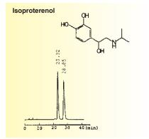
Column : SUMICHIRAL OA-4900 (250×4.6 mm) Mobile phase : hexane/1,2-dichloroethane/methanol/
